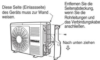
**⚠️ VORSICHT** • Berühren Sie nicht den Sauganschluss, die untere Fläche oder die Aluminiumlamellen des Außengeräts, da dies zu Verletzungen führen kann.
