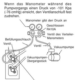
Bei Beginn des Pumpvorgangs, die Gewindemutter leicht lösen, um zu prüfen, ob Luft angesaugt wird. Dann die Gewindemutter wieder anziehen.
