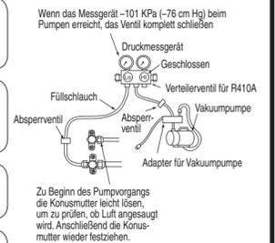
Wenn das Messgerät -101 kPa (-76 cm Hg) beim Pumpen erreicht, das Ventil komplett schließen
