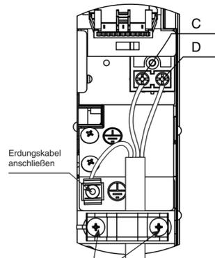
Nach dem Entfernen von Schraube und Abdeckung Verbindungsleitungen anschließen und die Abdeckung wieder mit der Schraube befestigen
