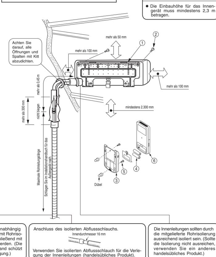
• Das Verbindungsrohr sollte unabhängig von seiner Größe vollständig mit Rohrisolierung abgedeckt und anschließend mit Vinylklebeband umwickelt werden. (Die Umwicklung mit Vinylklebeband schützt die Isolierung vor Beschädigung.)
