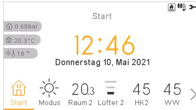
Die Hauptansicht des Geräts besteht aus einem unteren Registerkarten-Widget, mit dem Sie zwischen den verschiedenen Ansichten wechseln können:
