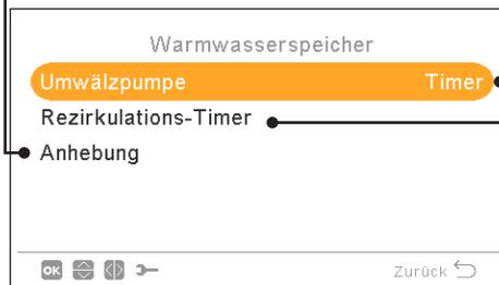
**Umwälzpumpe:** Durch Verwenden dieses Ausgangs kann der Benutzer das gesamte Wasser im Warmwasserleitungssystem erhitzen. Dieser Ausgang muss am E/A und im Fühler-Menü konfiguriert werden. (Siehe Abschnitt „11.13.3.11 Konfiguration der Eingänge, Ausgänge und Fühler“)
