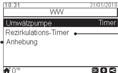
**Umwälzpumpe:** Durch Verwenden dieses Ausgangs kann der Benutzer das gesamte Wasser im Warmwasserleitungssystem erhitzen. Dieser Ausgang muss am E/A und im Fühler-Menü konfiguriert werden. (Siehe Abschnitt, [10.6.2.9 Konfiguration der Eingänge, Ausgänge und Fühler](#))
