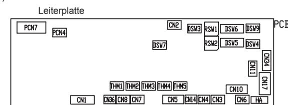
Elektrischer Schaltkasten für Innengerät
